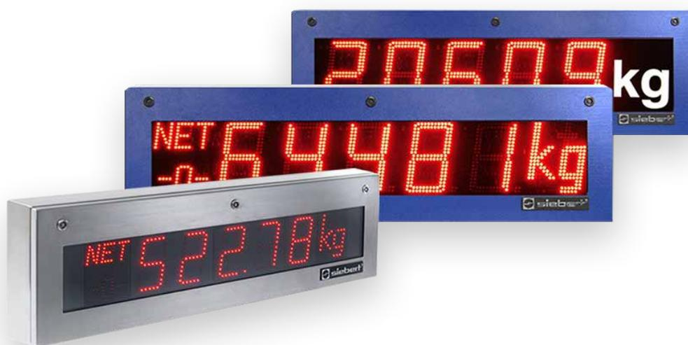
Die Grossanzeigen für die Wägetechnik sind spezielle Ausführungen der Serie S302. Sie besitzen eine vier- oder fünfstellige LED-Anzeige mit 57, 100, 160 oder 250 mm hohen Ziffern sowie ein Dimensionszeichen in Folienschrift oder LED-Technik.
