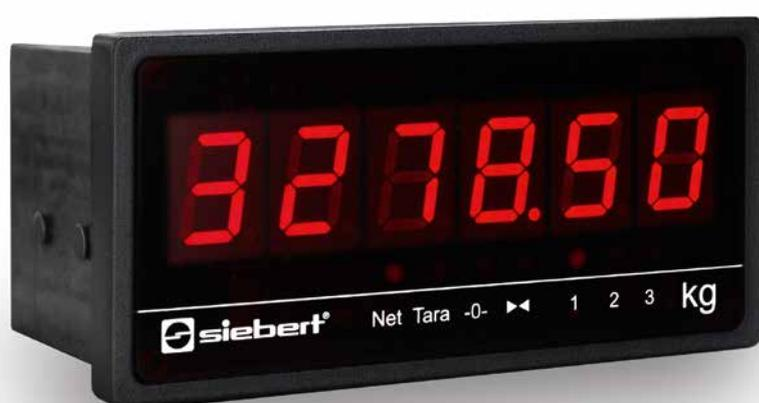
Die kompakten Geräte im 96 x 48 mm grossen Einbaugehäuse sind spezielle Ausführungen der Serie S102 und kompatibel zu den Wägerechnerfabrikaten Siemens Siwarex und Phoenix Contact. Sie besitzen Status-LEDs für Netto, Tara, -0-, >> und die Wägebereiche.
